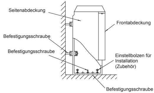
5. Installieren Sie das optionale Luftauslassgitter des RPFI-Geräts (siehe Abbildung unten). Beim Betrieb in einer Umgebung mit relativ hoher Luftfeuchtigkeit kann es zu Kondenswasserbildung kommen. Befestigen Sie aus diesem Grund um das Gitter herum ein Blech zum Auffangen des Kondenswassers, beispielsweise SUNKEN AQ von ASAHI Chemical Co.
